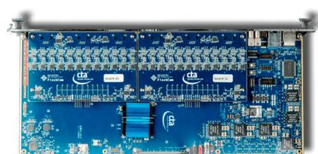
MPIK-Elektronik: FPGA-Platine mit 2 aufgesteckten Analog/Digital-Konverter-Platinen für je 12 Photomultiplier.
