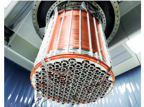
Das Herzstück von XENON1T, die Zeit-Projektionskammer.
